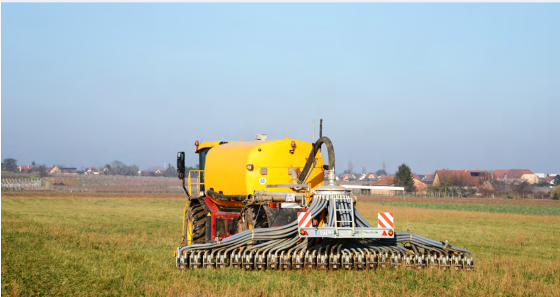
Foto 6.3: Mit dem Gölledrillverfahren wird das flüssige Vergärungsprodukt in den Oberboden abgelegt. Damit wird die Ammoniakverflüchtigung meistens stark reduziert.
